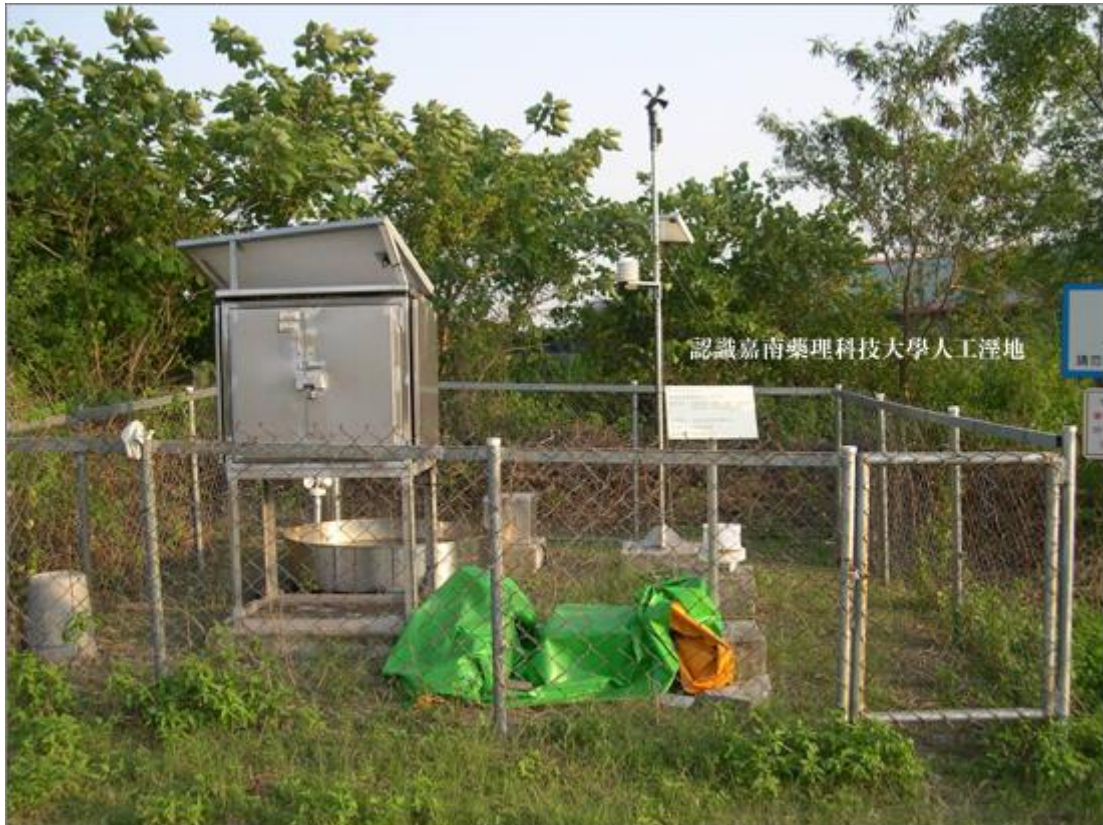
氣象資料監測站：提供研究所需資料，必要的電源來自太陽能
