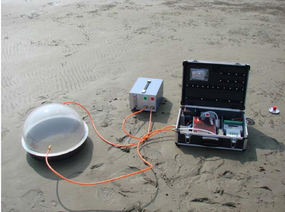
圖 45 高美濕地 CO<sub>2</sub> 吸收測量使用之密閉罩蓋法
