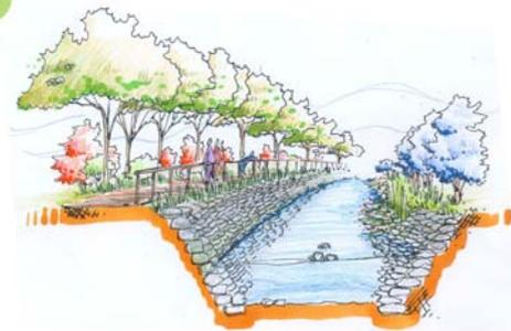
番仔寮溪的兩側護岸，可嘗試以生態工法的方式，分段營造，增加生物多樣性
