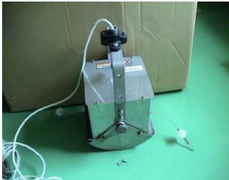
照片 2-5 艾克曼採泥器(Ekman dredge)
